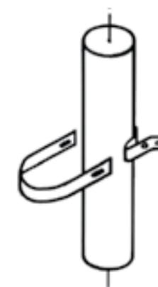
Tanto la abrazadera fija como la corrediza pueden asegurarse a los techos o paredes por medio de tornillos de acero o empotrarse por medio de un gancho de platina metálica.
