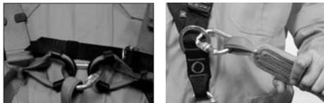
Conecte El estrobo (lado del amortiguador de impacto) al punto de anclaje del arnés (anillo pectoral) a través de un conector (mosquetón o maillón rápido);
