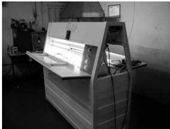
Figura 1. Fotografía de la cámara de intemperismo acelerado contruida que incluye sistema de control y adquisición automática de datos.
