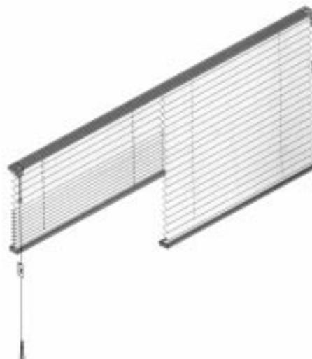
Consiste en dos cortinas estándar que compar ten un solo cabezal, que operan con dos frenos en forma independientes. Permite instalar paños de acuerdo a la modulación de las ventanas.
