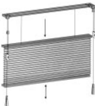
Sistema que permite abrir la cortina tanto desde arriba hacia abajo como de abajo hacia arriba, mediante dos frenos independientes, posibilitando dejar la entrada de luz en el espacio deseado.
