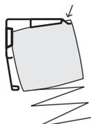
3.- Introduzca la lengüeta frontal del soporte de instalación dentro de la ranura superior del cabezal.
