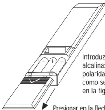
Introduzca las 3 pilas alcalinas AAA con la polaridad correcta como se muestra en la figura.
