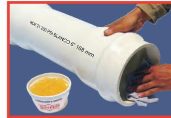
1. Limpie cuidadosamente antes de unir las campanas y los espigos. Para evitar su contacto con la tierra, utilice bloques de madera para soportarlos (estos bloques deben retirarse antes de iniciar el relleno).
