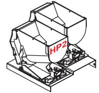
**Tipo HP** Configuración del tipo de descargador (HP1/HP2)
