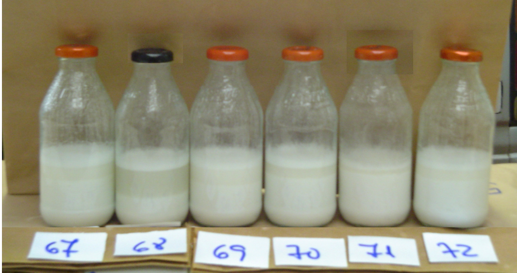
Figura 6: Separación de fases sin coadyuvante; valores extremos en los casos 68 (29 mm) y 71 (6 mm).
