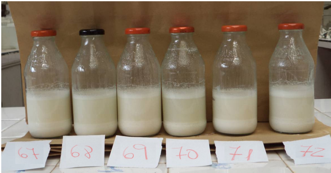
Figura 7: Separación de fases con coadyuvante; desmejoró en todos los casos, principalmente 70 a 72.
