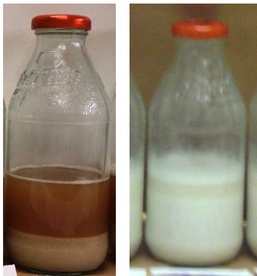
Figura 1: Sedimento (izq.), Menisco y Espuma (der.)
