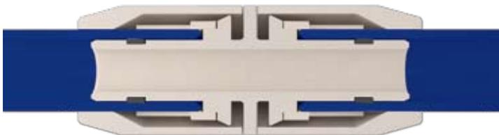
**Estanqueidad por el interior del tubo, mediante tecnología aplicada a sistemas de gas**
