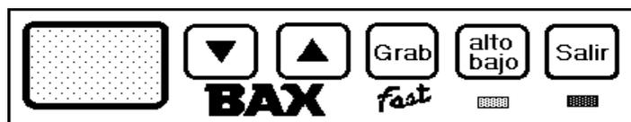
La tecla ALTO/BAJO muestra alternativamente en el display los dos dígitos más altos (con el punto que aparece en el extremo inferior derecho) , o los dígitos másbajos del código .
