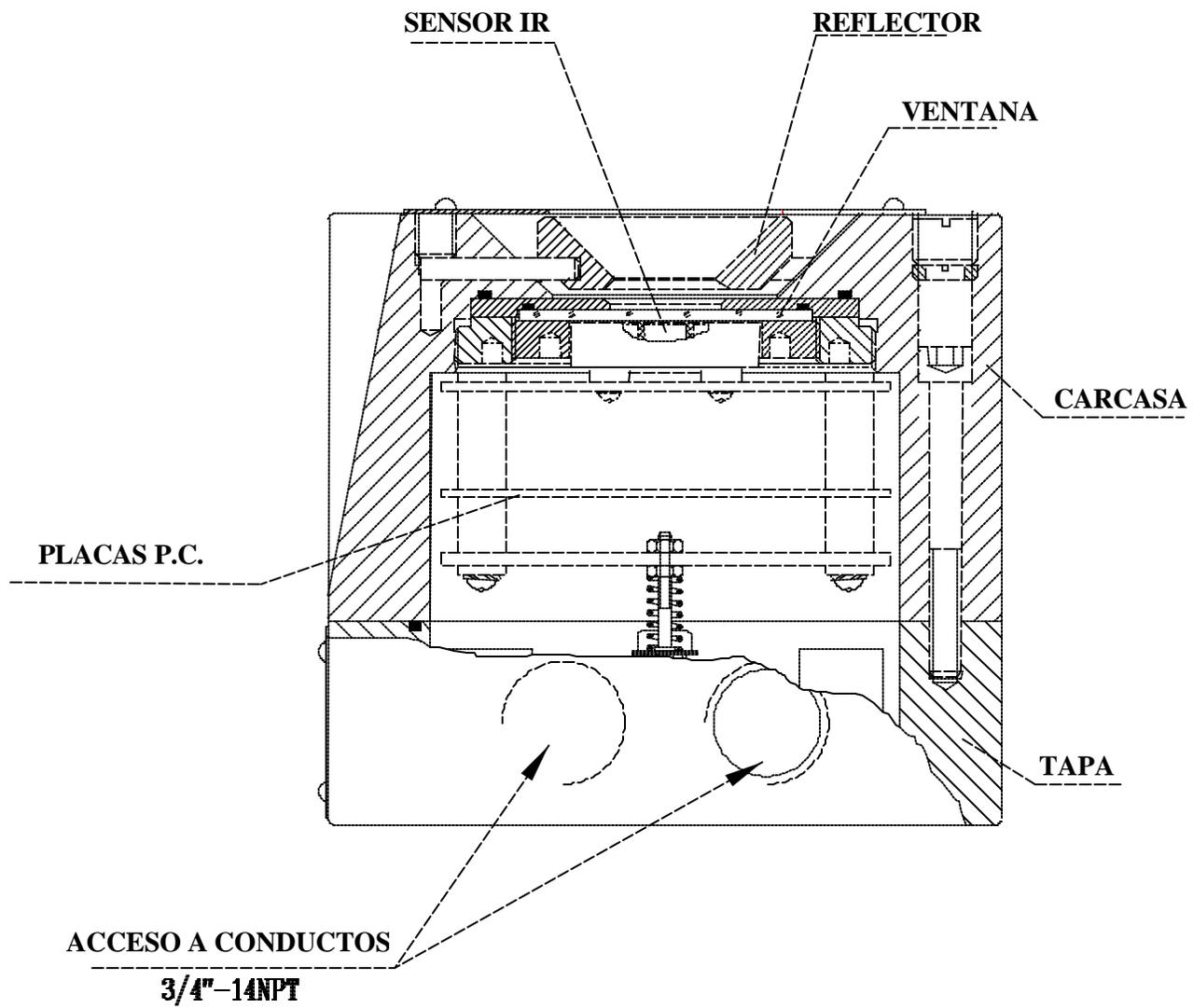
**Figura 6: Montaje del detector de llama - Sección esquemática**
