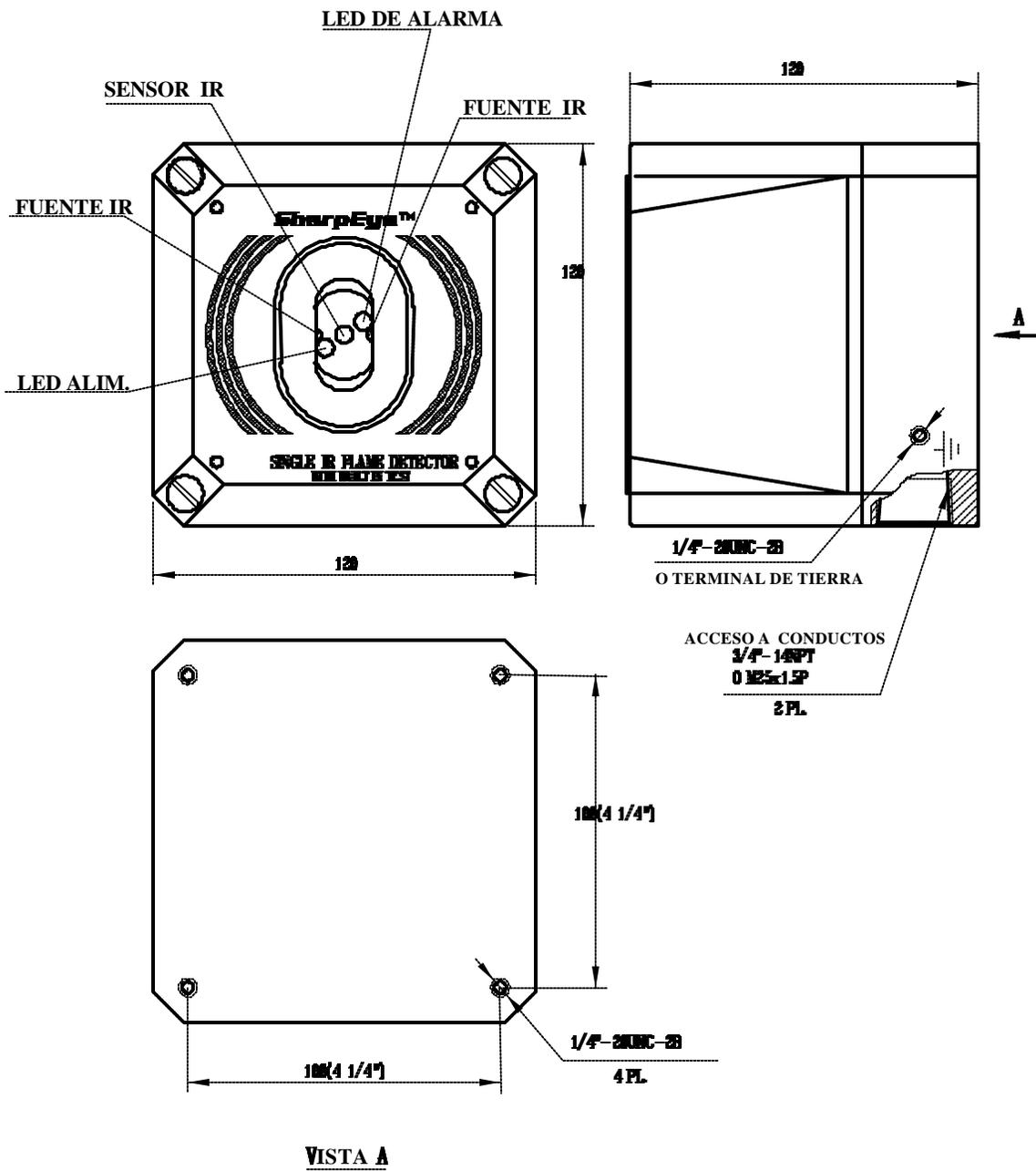
FIGURA 2: MONTAJE DEL DETECTOR DE LLAMA - GRÁFICO
