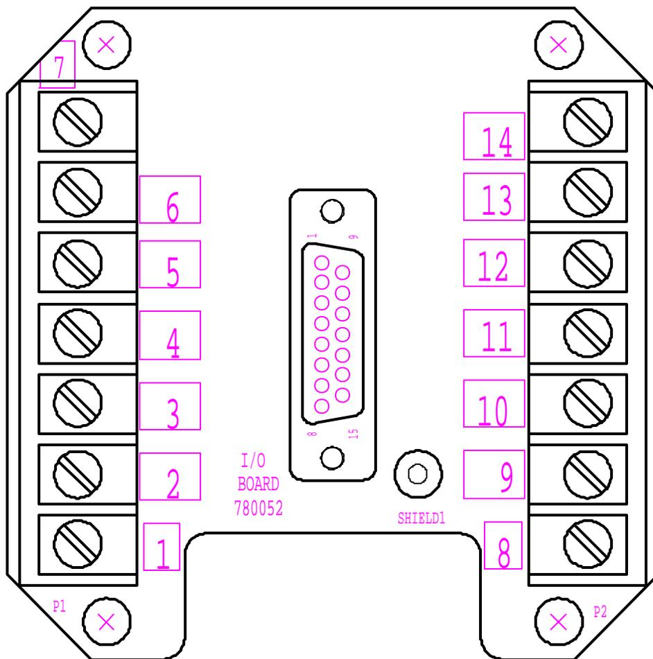
**FIGURA 9: PLACA DE TERMINALES**
