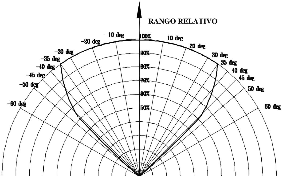
FIGURE 3: CAMPOS DE VISIÓN HORIZONTAL Y VERTICAL
