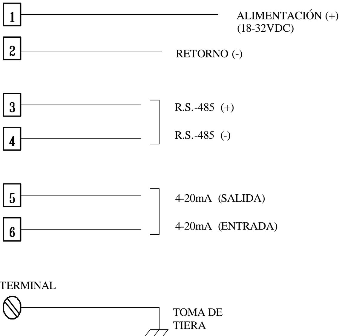
**FIGURA 18: DETECTOR DE LLAMA - DIAGRAMA DE CONEXIONADO (VERSIÓN "DE")**
