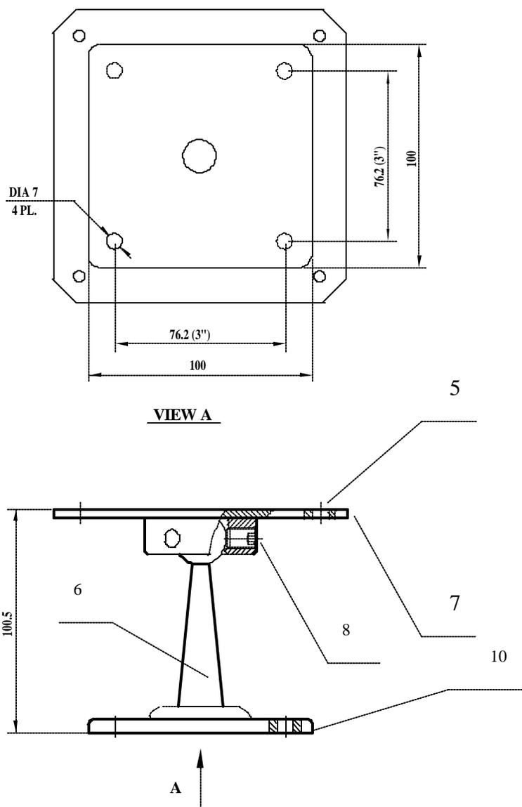
**FIGURA 8: MONTAJE DEL SOPORTE GIRATORIO - DIBUJO ESQUEMÁTICO**
