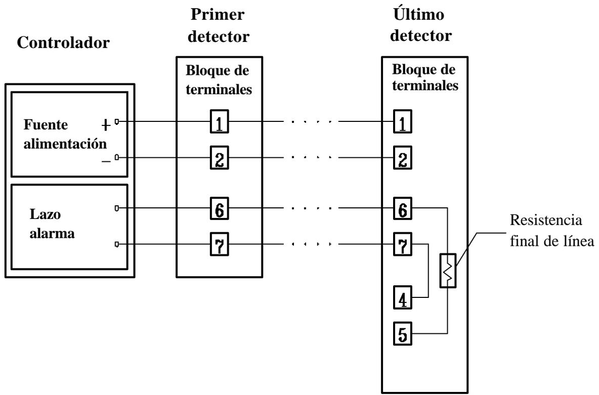
FIGURA 13: CONEXIONADO TÍPICO PARA CONTROLADORES DE 4 HILOS
