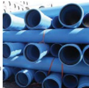
pasarse cuidadosamente desde la parte superior de la carga, pero las tuberías más pesadas requerirán el uso de cuerdas y deslizaderas. Durante la descarga de las hileras, las bandas entrelazadas se rompen para dar acceso a la siguiente hilera de abajo.
