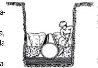
Elimine los huecos que hay debajo de la tubería
