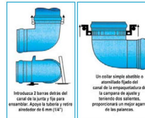
Introduzca 2 barras detrás del canal de la junta y fije para ensamblar. Apoye la tubería y retire alrededor de 6 mm (1/4")
