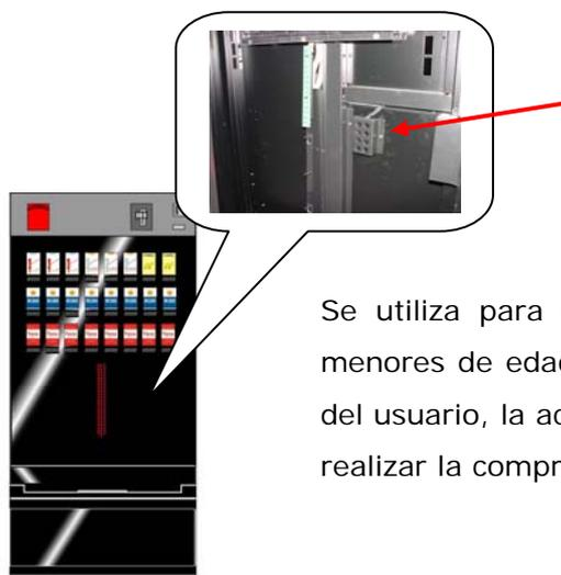
Se utiliza para controlar el acceso a la máquina de los menores de edad. El propietario de la máquina, a petición del usuario, la activa mediante este mando para que pueda realizar la compra del tabaco.
