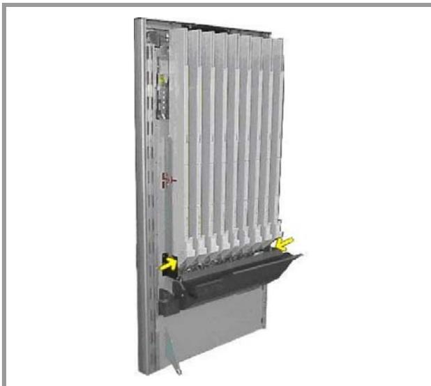
1. Con un destornillador de punta de estrella soltar los tornillos de transporte que se indican con las flechas amarillas en la figura lateral y abatir la parrilla de canales de la puerta.
