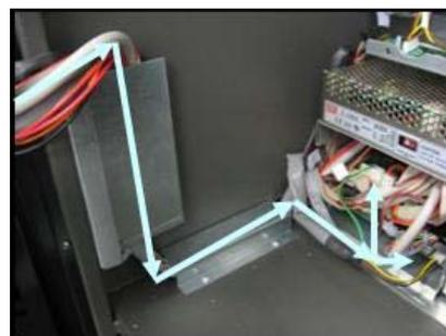
11. Conectar el cable de comunicación al puerto de la tarjeta control, conector J7 y la alimentación a la tarjeta entrada y salidas conector J12.
