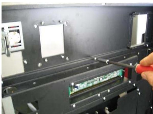
2. Con un destornillador de punta de estrella soltar los tornillos del embellecedor frontal.
