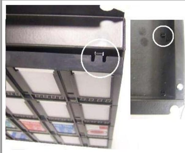
Desmontar el conjunto de tarjeta de pulsadores del panel, liberando los 4 clips que lo unen al panel de chapa
