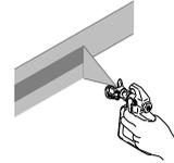
Dirigir la pistola hacia la zona a pulverizar a 30 cm aproximadamente de la superficie, y empezar a moverla antes de dispararla. Se obtiene un buen acabado cuando el abanico se aplica de manera uniforme al tocar la superficie. La presión debe ser suficiente para poder pulverizar sin que se formen bordes espesos en los lados. Si el acabado no es uniforme, ajustar la talla de la boquilla : más pequeña para los productos más fluidos y más grande para los productos espesos.
