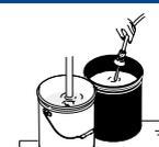
Colocar el tubo de aspiración en el cubo de pintura pero dejar el tubo de drenaje en el cubo de agua.
