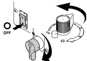
Posicionar el interruptor de alimentación eléctrica en OFF, girar el botón de control de presión hasta el ajuste más bajo y colocar la válvula de purga en Purga (hacia abajo).
