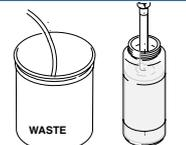
Colocar el tubo de drenaje en un recipiente de desecho y el tubo sifón/ de aspiración en un recipiente de Pump Armor™.
