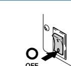
Cuando comience a salir el Pump Armor del tubo de drenaje, colocar el interruptor de alimentación en OFF.
