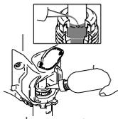
Llenar el prensaestopas con líquido TSL para evitar el desgaste prematuro de las empaquetaduras.
