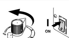
Girar el botón de control de presión hasta el ajuste más bajo, posicionar el interruptor en ON y aumentar la presión hasta que el pulverizador arranque. Dejar que funcione y que se limpie automáticamente durante 2 minutos.
