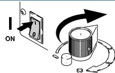
Colocar el interruptor de alimentación eléctrica en ON, y aumentar la presión hasta que el pulverizador arranque.
