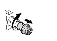
Gire y tire hacia afuera del conector, hasta la posición completamente extendida.
