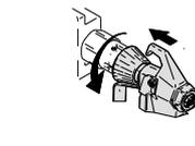
Empuje y gire la pistola hasta que los pasadores del conector estén seguros en las ranuras. Así se abre la válvula AutoClean.
