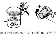
Para recuperar la pintura de la manguera y de la bomba, dispare la pistola hacia el interior del cubo de pintura y aumente la presión. Cuando comience a salir el líquido de limpieza, suelte el gatillo.
