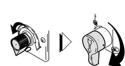
Reduzca completamente la presión. Abra la válvula de drenaje.
