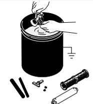
Desenroscar la boquilla y su soporte de la pistola. Limpiar el filtro de pistola, la malla de entrada, la boquilla, el soporte y el filtro colector con agua y cepillo.
