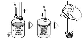
Retire de la pintura los tubos de aspiración y de drenaje. Coloque el tubo de drenaje en un recipiente de desecho y limpie el tubo de drenaje.
