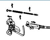
Enroscar la malla de entrada en el tubo sifón, volver a colocar el filtro colector y la junta y montar la pistola con el filtro, la boquilla y el soporte.
