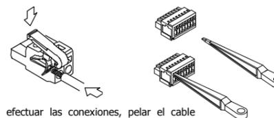
Para efectuar las conexiones, pelar el cable dejando entre 7 y 10mm al aire e introducirlo en el terminal presionando la tecla o con la palanca.
