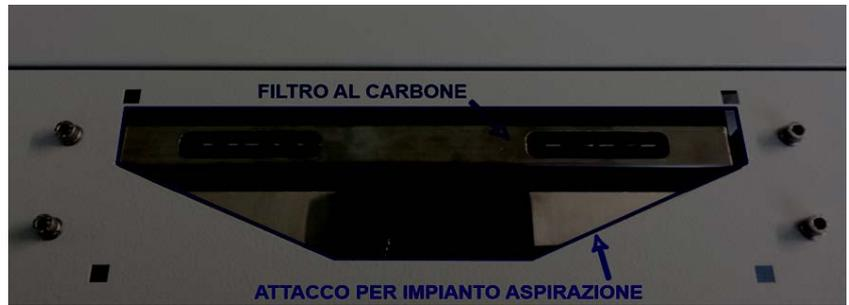
Anotación: Si el instrumento se conecta a la instalación de aspiración humos es necesario remover el filtro de carbón y desactivar los rotores de aspiración del instrumento.
