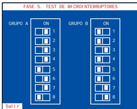
Visualización del estado de los microinterruptores de configuración y verificación de su funcionamiento.
