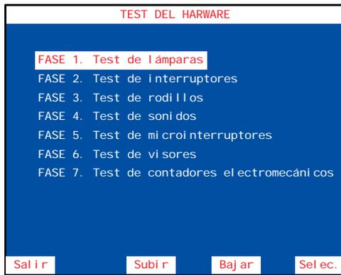
El menú **TEST DEL HARDWARE** permite acceder a diferentes fases cuya finalidad es verificar el funcionamiento de la máquina.
