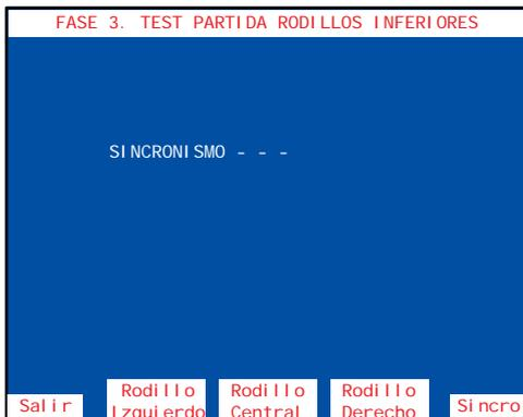
Con el pulsador **8**, se efectúan sucesivas partidas de alineamiento. Con los pulsadores **3**, **4** y **5**, correspondientes a cada rodillo, se realizan avances de figura a figura, indicando en la pantalla su posición en la banda del rodillo.
