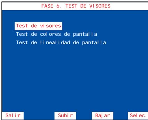
El menú **TEST DE VISORES** permite acceder a tres fases cuya finalidad es comprobar los visores display de siete segmentos y facilitar el mantenimiento de los circuitos de video y monitor TFT.
