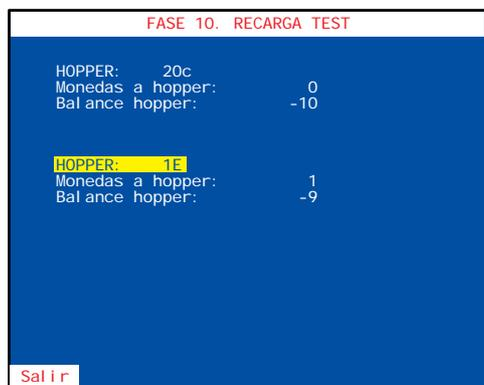
Permite recargar las monedas extraídas en la **fase 9 Descarga test** y devolverlas a través del selector, hasta conseguir el **balance hopper a CERO**, para no alterar la contabilidad. Para realizar esta fase cerrar la puerta.
