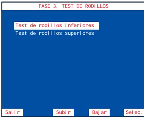
El menú **TEST DE RODILLOS** permite acceder a dos fases cuya finalidad es verificar el funcionamiento de los rodillos inferiores y superiores.
