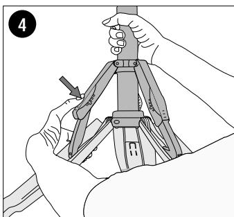
**▲MISE EN GARDE :** S'assurer que le trépied est fixé solidement en place sur une surface plane et stable.
