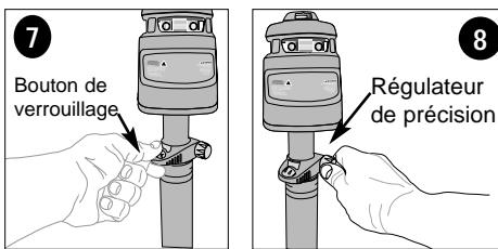
Une fois la hauteur voulue obtenue, soulever le laser jusqu'à la hauteur finale choisie au moyen du régulateur de précision (figure 8); ce dernier permet de soulever le laser jusqu'à une hauteur additionnelle d'environ 178 mm (7 po). Pour ce faire, desserrer le bouton de verrouillage en suivant l'illustration à la figure 7.
