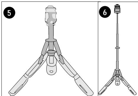
Extienda cualquiera de o todas las 5 secciones del trípode para alcanzar la altura aproximada deseada. Deslice suavemente cada tubo hacia afuera para extender cada sección hasta que se detenga, luego tire de cada sección con un poco más de firmeza para bloquearla. Cuando alcance la altura aproximada deseada, use el botón de puesta a punto mostrado en la figura 8 para elevar el láser a la altura final deseada. El botón de puesta a punto elevará el láser unos 178 mm (7 pulg.) adicionales.
