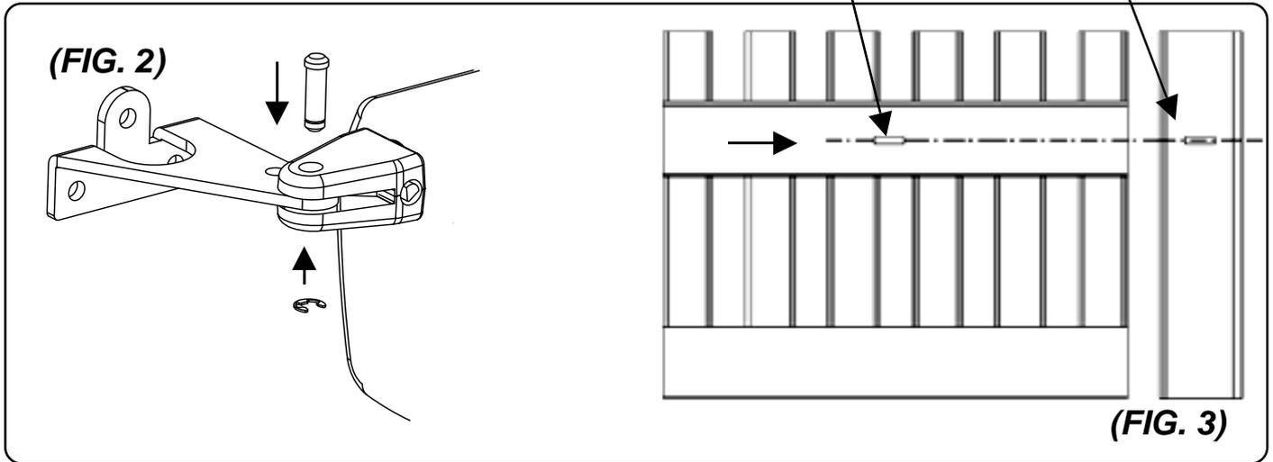
**¡Atención!** Cuando se establece la altura desde el suelo donde fijar la placa en el pilar (FIG.1), tener en cuenta que la placa para el anclaje del pistón en la cancela debe estar fijada al mismo nivel . (FIG.3)
