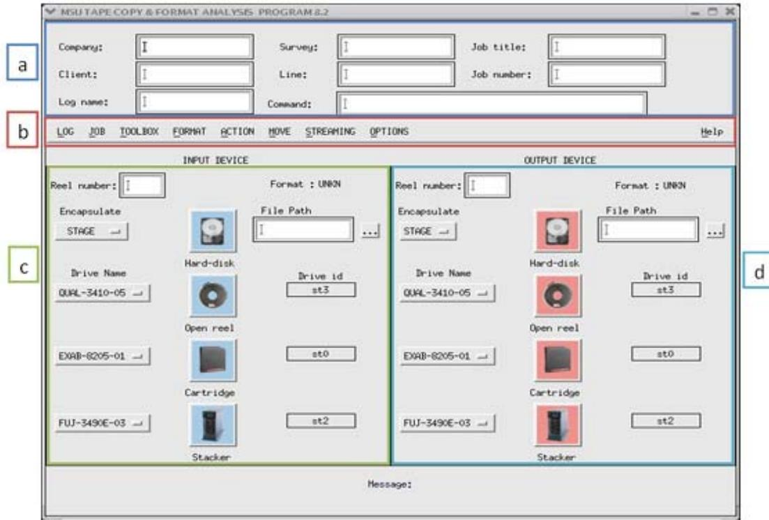
Figura 2.- Interfaz Gráfica M5U. a) tablero superior, b) menú principal, c) área del dispositivo de entrada, d) área del Dispositivo de salida.
