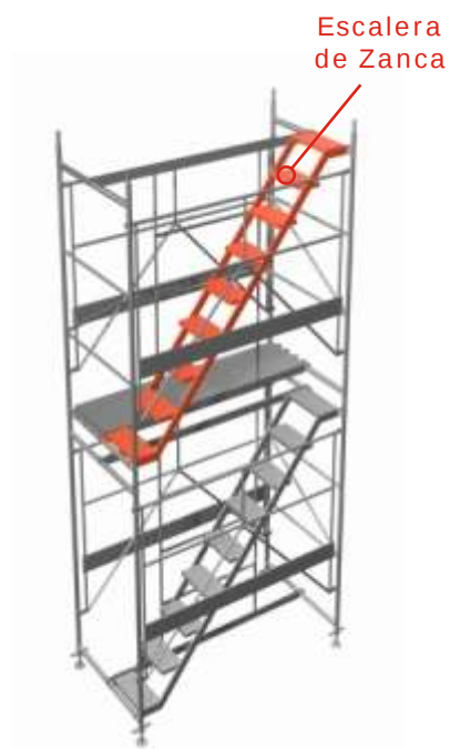
10. Montamos otra Escalera de Zanca sobre las horizontales de los Pórticos.
