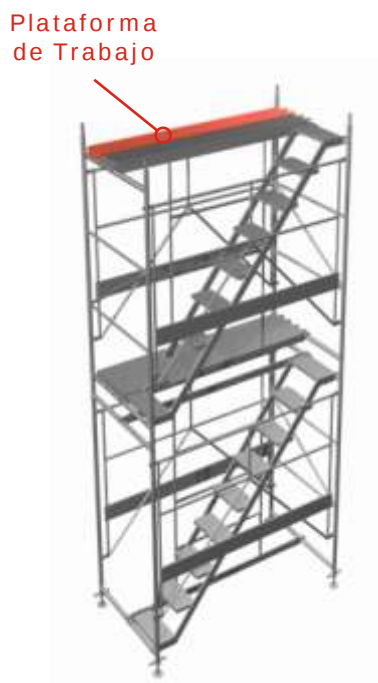
11. Se colocan las Plataformas de Trabajo (Panacier)
