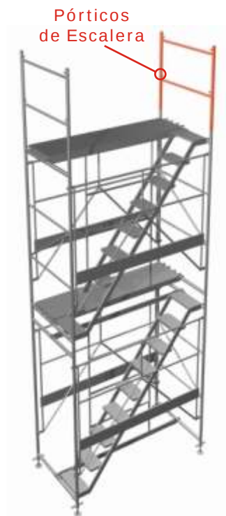
12. Posicionamos los Pórticos de Escalera.
