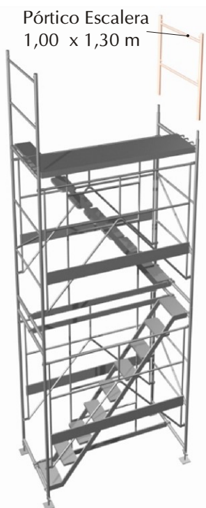
11. Se colocan los Pórticos de Escalera.
