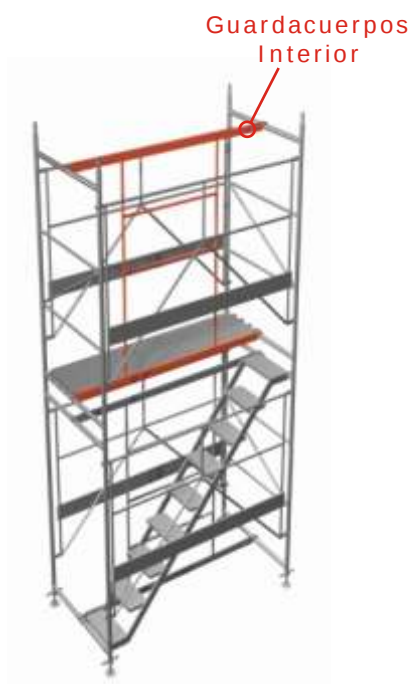
9. Colocamos el Guardacuerpos Interior sobre los Pórticos.
