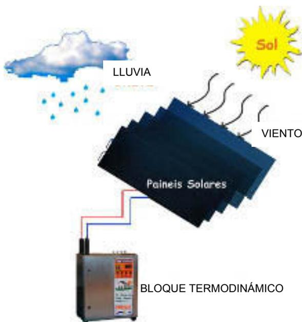
El compresor aspira el fluido frigorífico (vapor) del panel elevando la presión y la temperatura del mismo, que es transmitida al circuito de agua mediante un intercambiador de calor.
