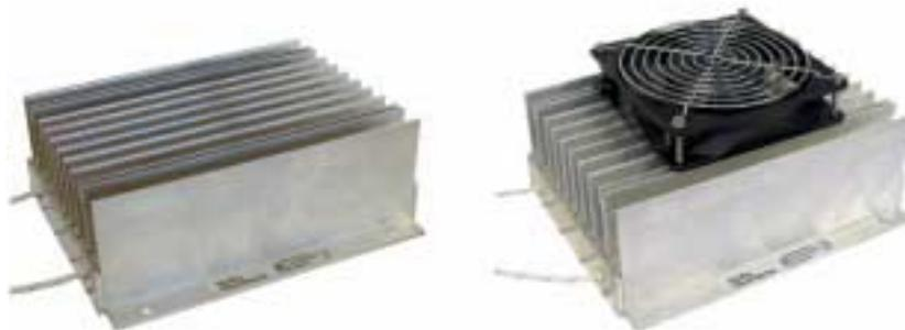
Para aumentar la capacidad, algunas resistencias de frenado REO pueden montarse con un ventilador. Por ejemplo, en el disipador del BW 155 hay ranuras en forma de "T" aptas para instalar un ventilador si se requiere potencia extra (en este caso se dobla el valor de potencia).
