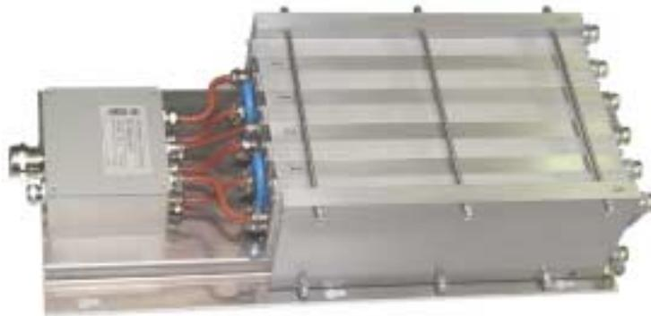
En el dibujo puede verse que hay seis elementos resistores conectados a través de prensa stops EMC, a una caja terminal central. Entre las resistencias hay cuatro módulos de enfriamiento por agua y el ensamblaje total se asegura con una placa base con placas laterales y tuercas fijadoras. Este diseño está disponible en REO con series de valores de 20 - 130kW (ficha técnica disponible bajo demanda).
