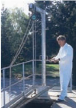
Un peso de 37 kg permite un desplazamiento fácil del pescante de acero inoxidable sobre otras bases en puesto fijo.
