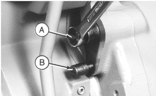
(PMS) en su carrera de compresión. Insertar el pasador de sincronización JDE81-4 o JDG1571 (B) en su alojamiento en el volante.
