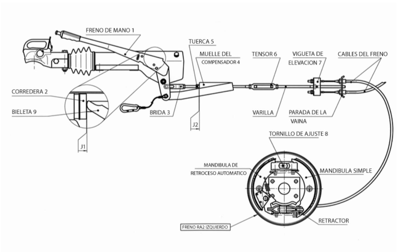
**Figura 4.3 :** Transmisión de frenado
