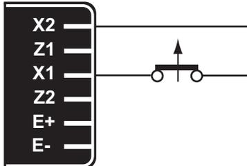
El corte de la excitación se obtiene interrumpiendo la alimentación del regulador (1 hilo -X1 ó X2).
