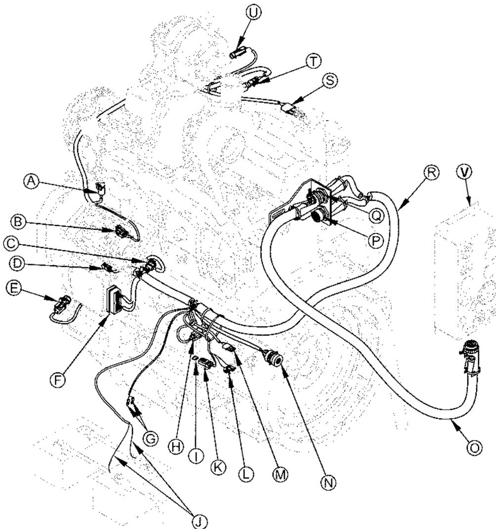
A—Conector del sensor de temperatura del refrigerante
