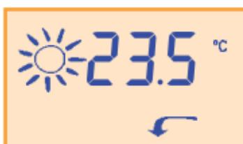
Pantalla que muestra la temperatura, la previsión del tiempo y la tendencia de la presión atmosférica.
