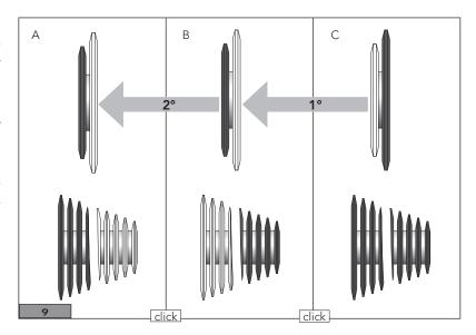
• Desde la Pos. A, si se está bajando con el cambio en los piñones más pequeños, para evitar el roce de la cadena en la patilla, se podrá efectuar un accionamiento de la maneta hacia arriba (1.er accionamiento – Fig. 10).
