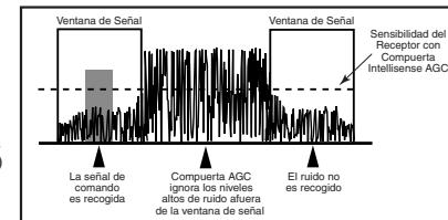
Es responsabilidad del instalador probar la fuerza de la señal y presencia de ruido usando los equipos de prueba de Leviton, No. de Cat. 6385 (Transmisor de Prueba de Señal) y 6386 (Indicador de Fuerza de Señal), y aplicar apropiadamente el equipo acoplador de señal y redutor de ruido de acuerdo a las instrucciones proporcionadas en el Manual Técnico y Guía de Solución de Problemas DHC.
