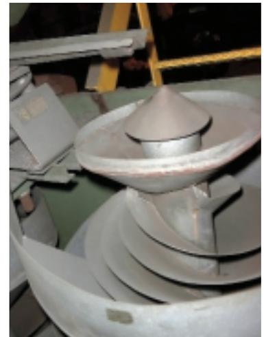
**FIGURA 12-4** Separador de Bolas de Shot Peening
