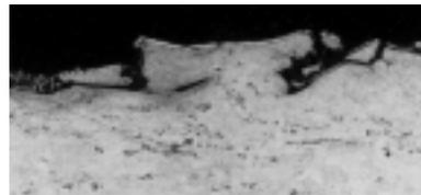
FIGURA 12-2A Daño de Superficie Creado por Bolas Rotas
