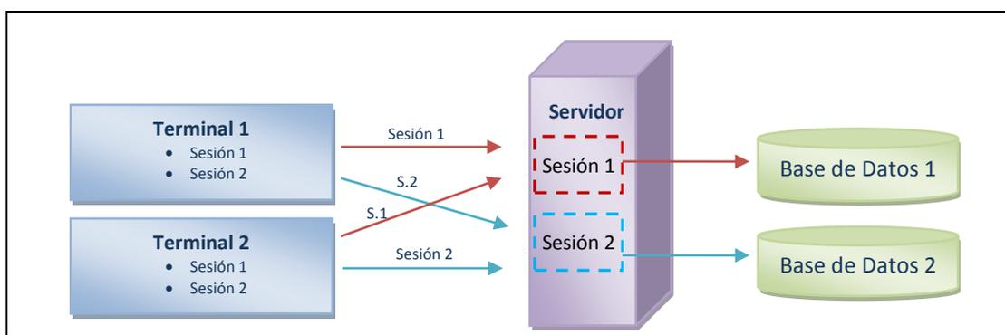
El esquema anterior ilustra cómo cada terminal del usuario puede tener tantas sesiones del sistema como desee (según se hayan previamente instalado y configurado), cada una apuntando a una única base de datos (empresa) siempre a través de la misma aplicación servidora de reglas del negocio (aunque residen todas en un único servidor de red), sin posibilidad de modificar dicha condición.
