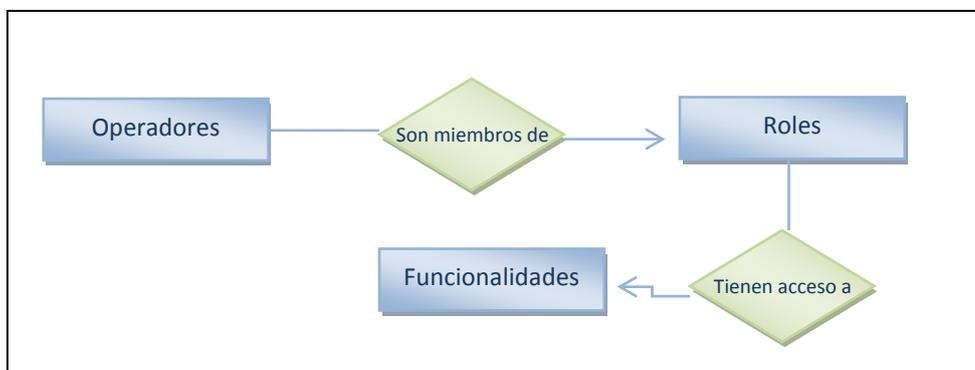
Los **operadores**, si bien tienen ciertos atributos particulares (usuario, clave, bloqueo, lleva tracking, etc.), no poseen una configuración de seguridad. La seguridad se establece a nivel de **grupo** o **rol**. La unión de los operadores con los grupos queda establecida en la tabla de **miembros** (*wld\_miembros\_grupo*). Cada operador puede pertenecer a varios grupos. El nivel de seguridad obtenido será el máximo posible dada la combinación de todos ellos.
