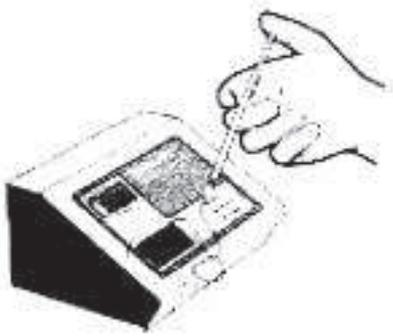
El instrumento debe calibrarse si se ha sustituido la célula de conductividad o si se determina que es necesario recalibrar (ver Chequeos del Sistema, Sección 2.4). Existen dos factores comunes que puede influenciar la lectura, por lo que, antes de recalibrar, asegurarse de comprobar lo siguiente:
