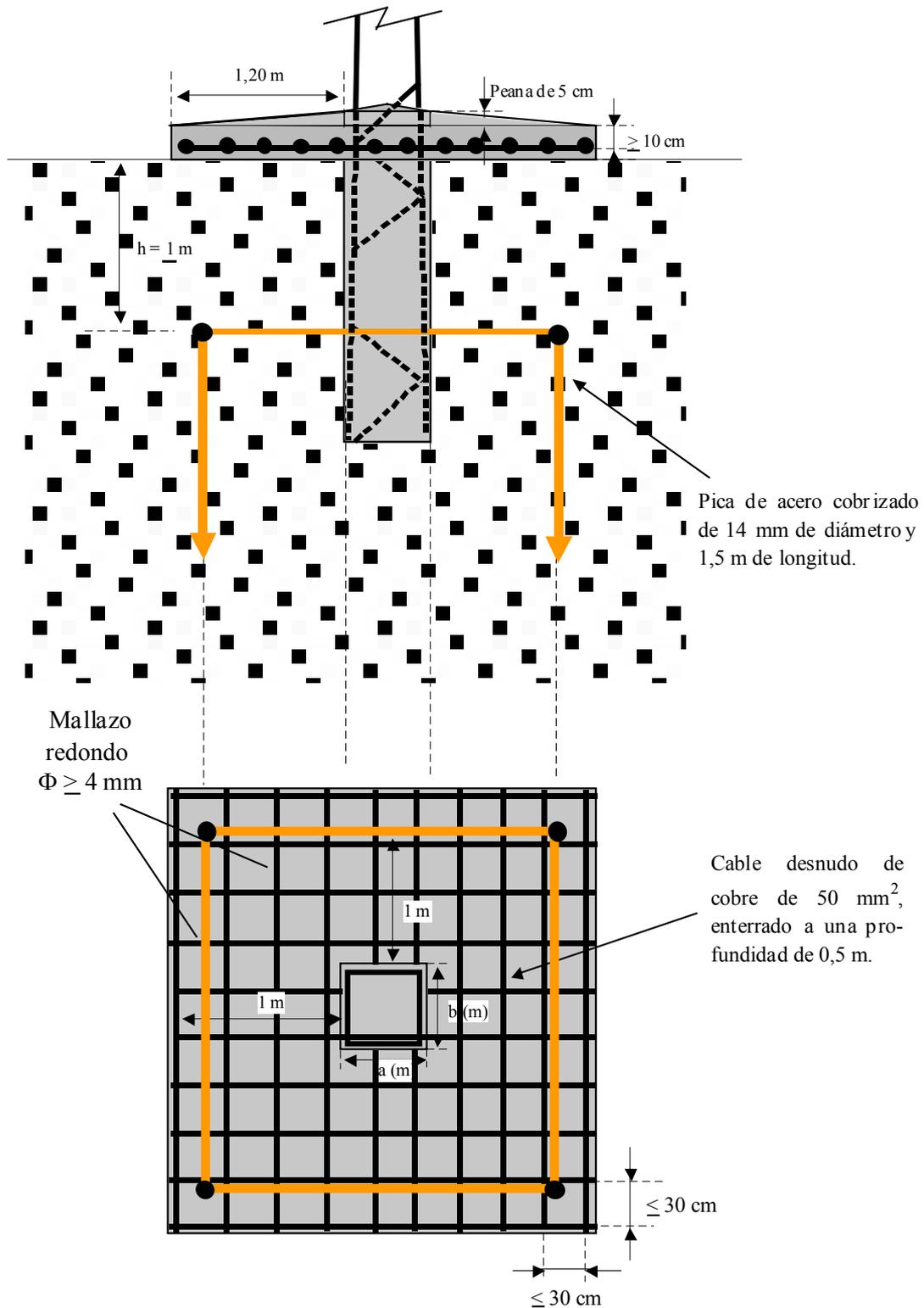
Figura 9.- Acera de hormigón, con mallazo equipotencial, perimetral con la cimentación del apoyo, empleado en líneas aéreas con apoyos frecuentados sin calzado.
