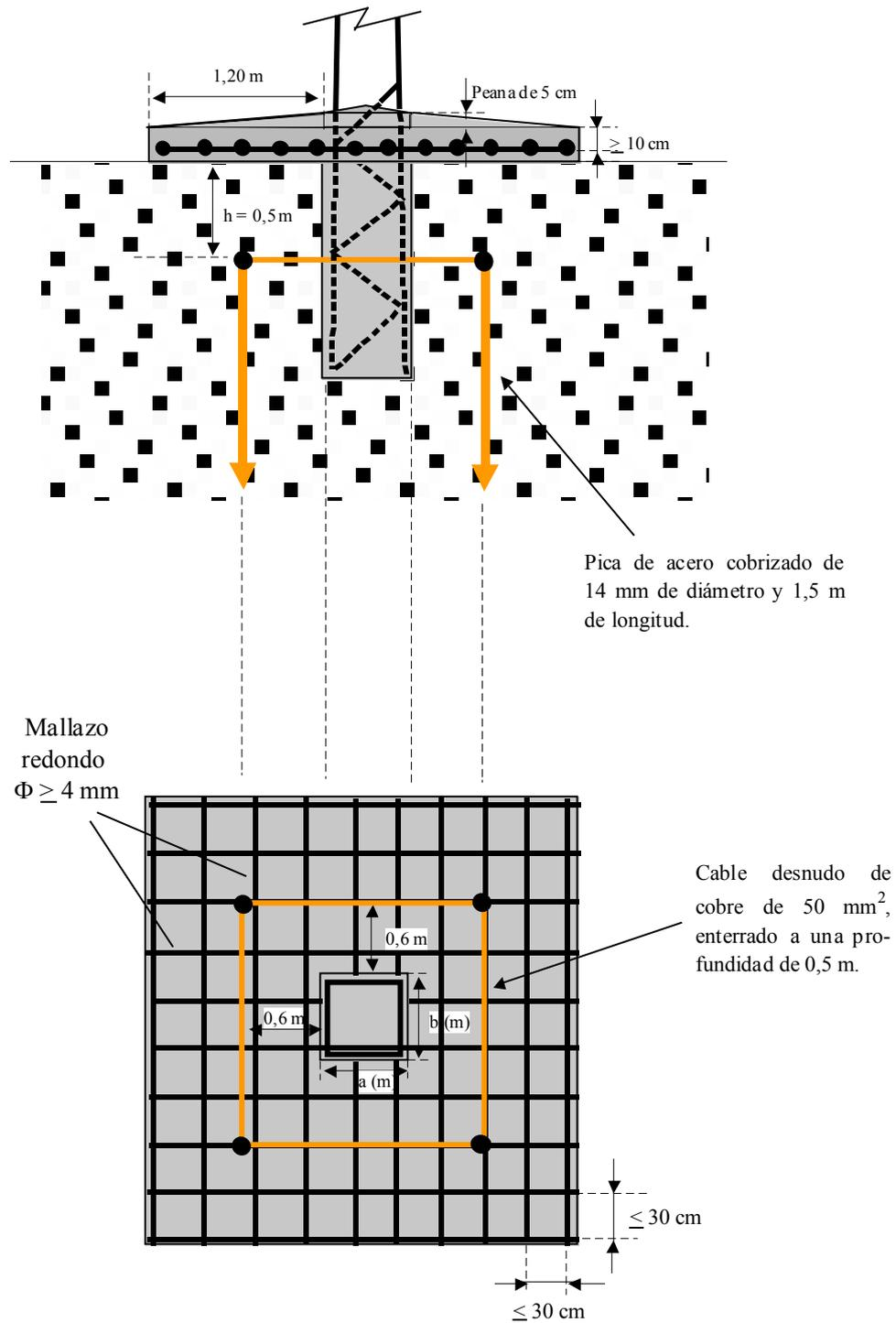
Figura 8.- Acera de hormigón, con mallazo equipotencial, perimetral con la cimentación del apoyo, empleado en líneas aéreas con apoyos frecuentados con calzado.
