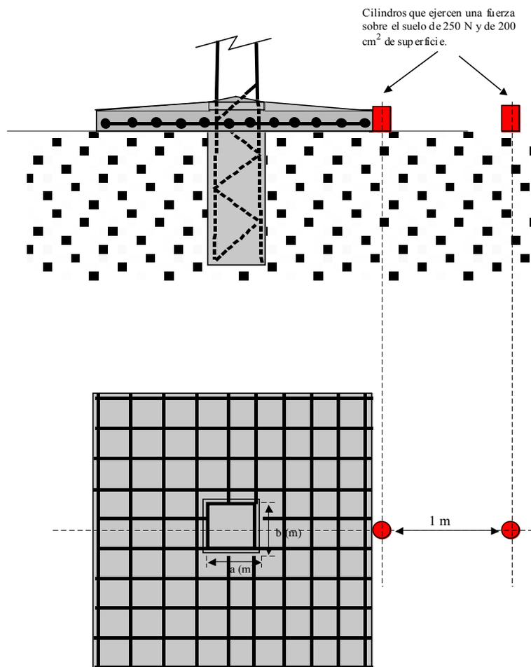
Figura 2. Medida de la tensión de paso en sentido longitudinal o transversal de la cimentación.
