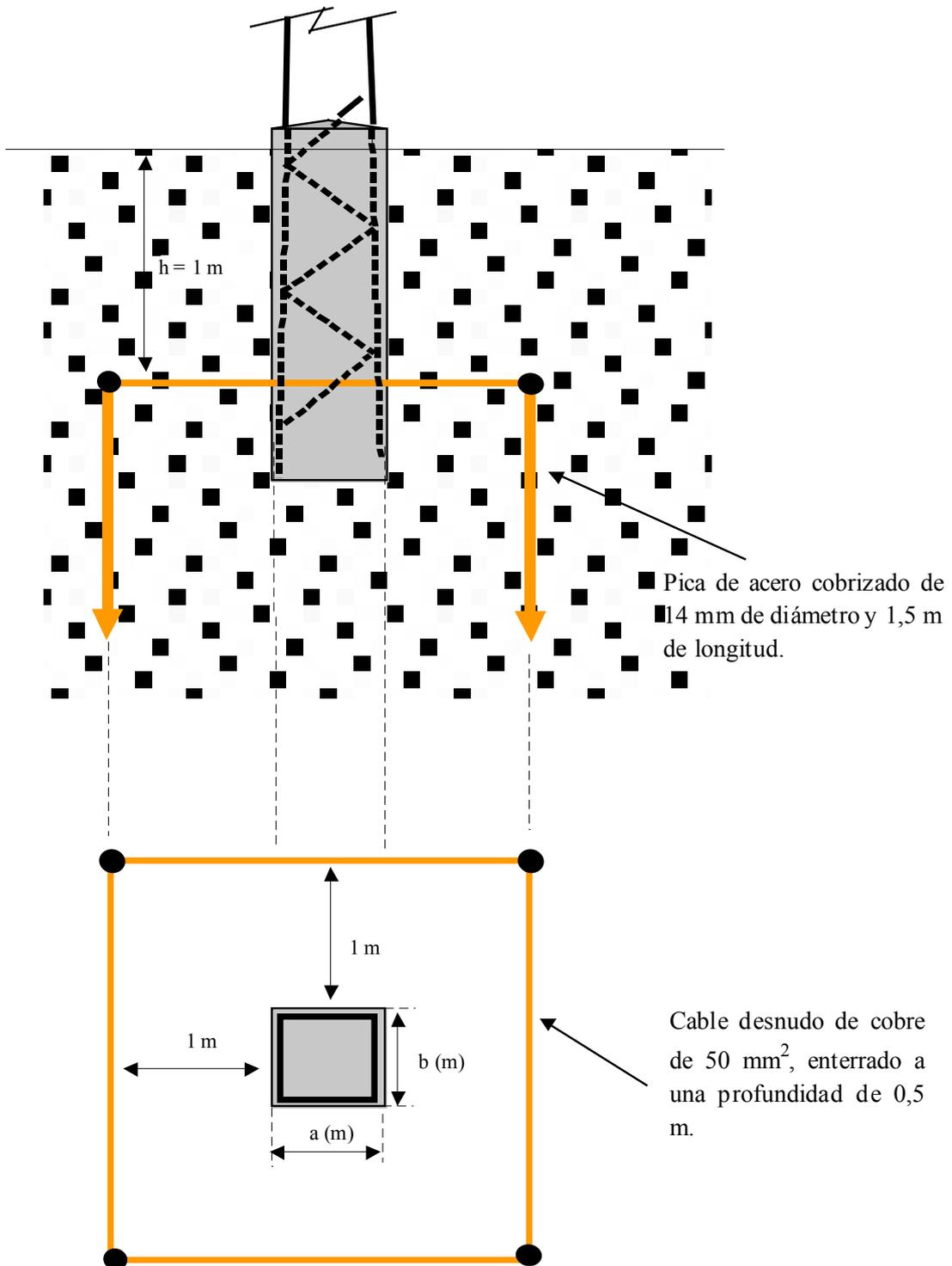
Figura 4. Configuración del electrodo de puesta a tierra para apoyos frecuentados sin calzado.
