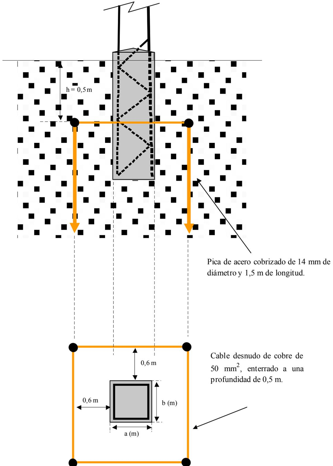
Figura 3. Configuración del electrodo de puesta a tierra para apoyos frecuentados con calzado.
