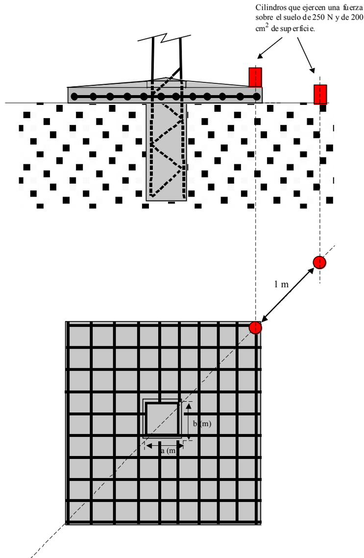
Figura 1. Medida de la tensión de paso en el sentido de la diagonal de la cimentación.
