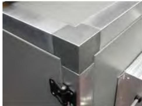
Sobre dicha bancada se disponen bastidores fabricados en aluminio anodizado protegido contra la intemperie y que permite el montaje de grandes paneles para el acceso y mantenimiento de la unidad. Estos paneles están fabricados en chapa de acero galvanizado con protección plástica tipo Skin-Plate que asegura su perfecta protección contra corrosiones o deterioro del color.
