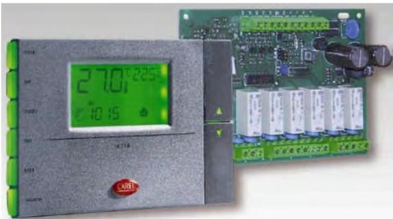
Aria es un controlador electrónico que dispone de un terminal de ambiente que se comunica con una tarjeta de potencia que se instala en el interior del cuadro eléctrico de la unidad. Dispone de un display LCD retroiluminado con un interface de usuario en el que se accede a los parámetros y a los modos de funcionamiento.
