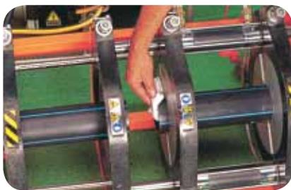
4. Tapone los extremos que no está soldando. Posicione la plancha de calentamiento y junte los extremos de los tubos aplicando la presión determinada antes.
