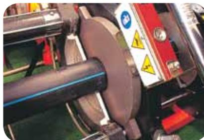
6. Mantenga los extremos de los tubos en contacto con la plancha de calentamiento durante el tiempo de calentamiento (T2). Ver Tabla #1
