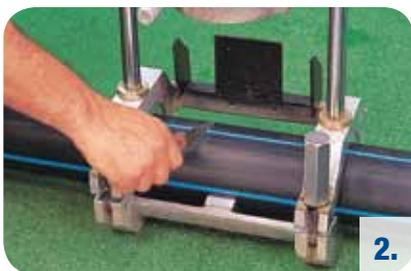
3. Fije el accesorio al soporte que posee la máquina y controle el correcto ajuste. Accione la palanca de la herramienta de aplicación hasta alinear el tubo y el accesorio.
