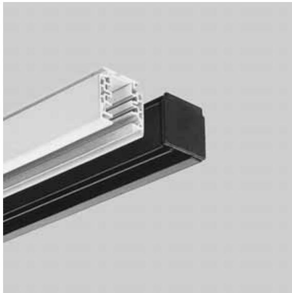
**carril trifásico de 5 conductores con tres circuitos y con encendido separado.** provisto de agujeros para la fijación, está formado por un perfil de aluminio extrudido, que funciona también como conductor de tierra, y por una pieza interior de plástico que aloja cuatro conductores de cobre de 3mm. es posible cortar el carril de acuerdo con la longitud deseada, sin tener que doblar o cortar necesariamente el conductor de cobre. bajo pedido, están disponibles los accesorios para la instalación.
