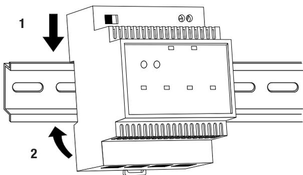
Asegurarse de que el dispositivo esté bien fijado en el carril DIN.
