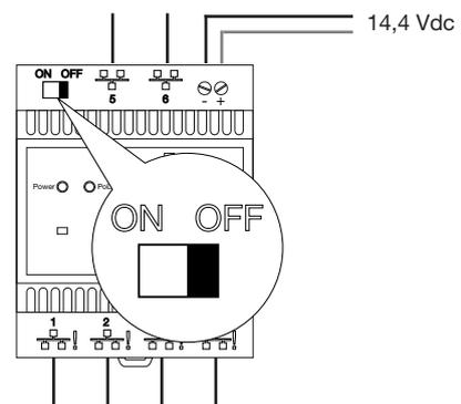
Portas LAN 1÷4 (PoL desabilitada), conexões Ethernet para:
