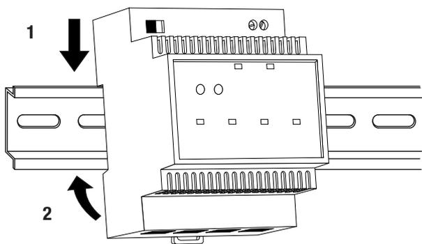
Accertarsi che il dispositivo sia ben fissato sulla guida DIN.
