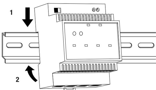
Certificar-se de que o dispositivo esteja bem fixado na calha DIN.
