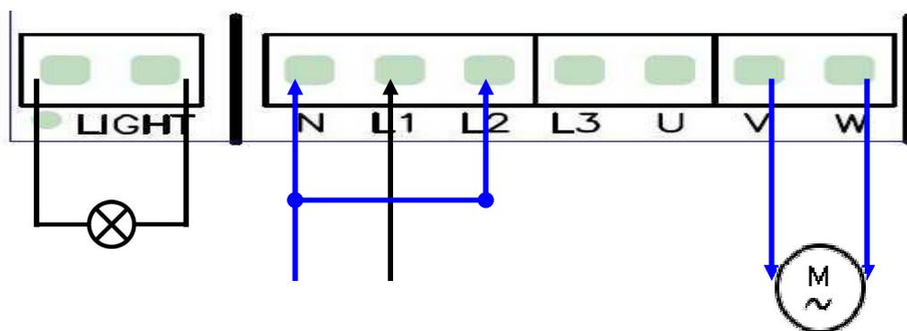
**CONEXIONADO PARA ILUMINACIÓN Y LA BOMBA DE FILTRACIÓN 230V ac II**
