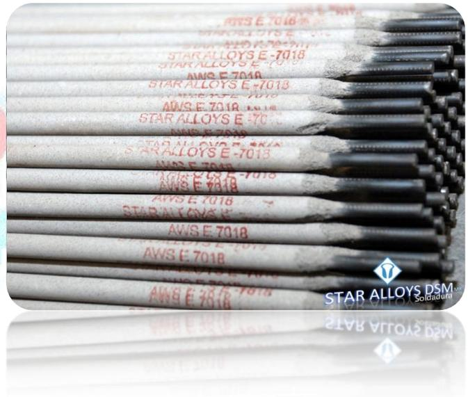
Nunca se deben dejar los electrodos directamente en el piso. Una vez abierto el empaque de los electrodos, deberán ser secados y almacenados necesariamente. Nunca los deje a temperatura ambiente.
