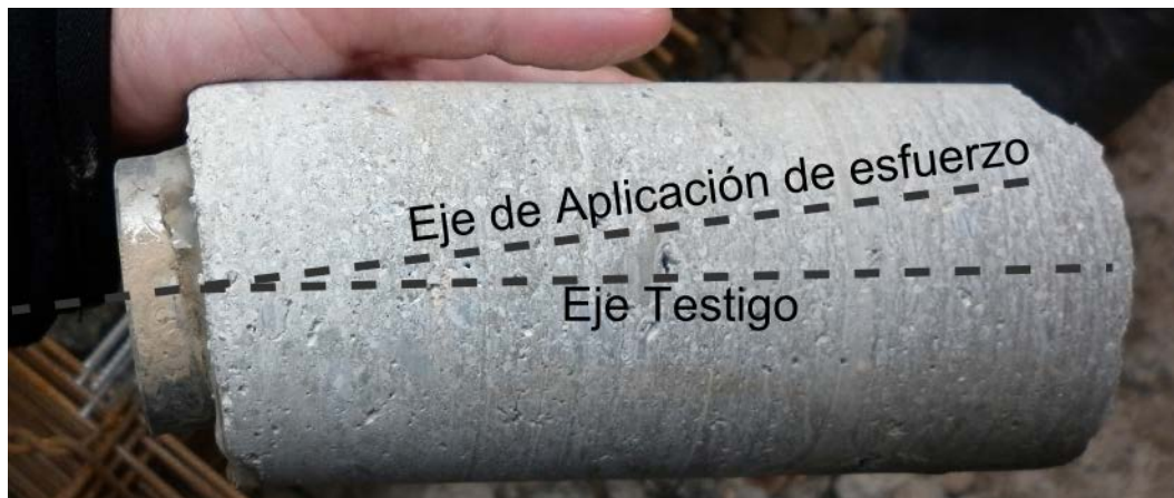
Fig. 67 - Ejemplo de desalineaciones sufridas durante la realización del ensayo pull-off
