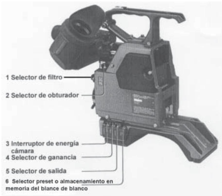
3. Interruptor de energía de la cámara (PREHEAT/ON)/VTR (SAVE/STBY)
