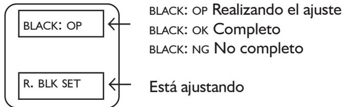
Si el selector *negro/ajuste* de balance de negros no se completa, en la pantalla del *viewfinder* se despliega BLACK: NG siempre con una de las siguientes notas explicatorias. Se debe realizar la selección de *negro/ajuste* del balance de negros nuevamente.
