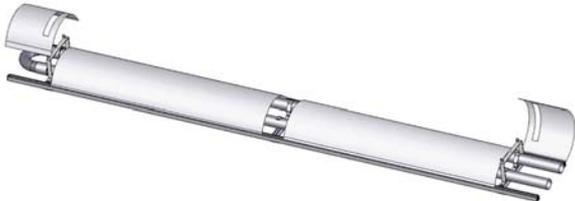
11. Montar los reflectores cortos « abiertos » empalmado 50 mm sobre los dos reflectores previamente colocados y fijándolos hasta hacer “clic” entre los dos perfiles de la estructura-soporte.
