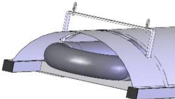
13. Colocar los mosquetones en los dos soportes de sujeción.
