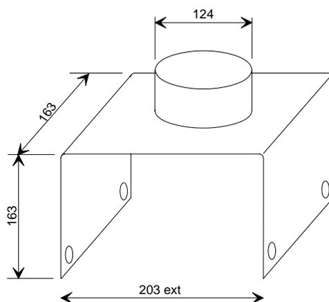
El kit de adaptación se coloca en lugar de la tapa del cajón quemador.
