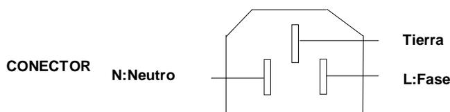
Recomendamos la utilización de un cable flexible multiconductor, con conductores cuya sección mínima sea 1,5 mm<sup>2</sup>
