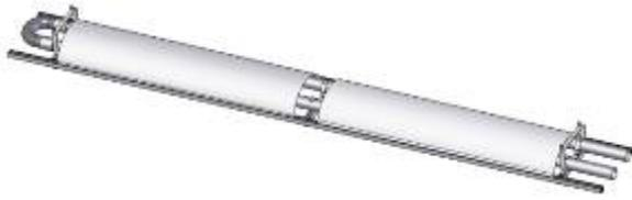
10. Montar los dos reflectores largos forzando la chapa manualmente hasta fijarla entre los dos perfiles de la estructura-soporte evitando que se marque o se doble.
