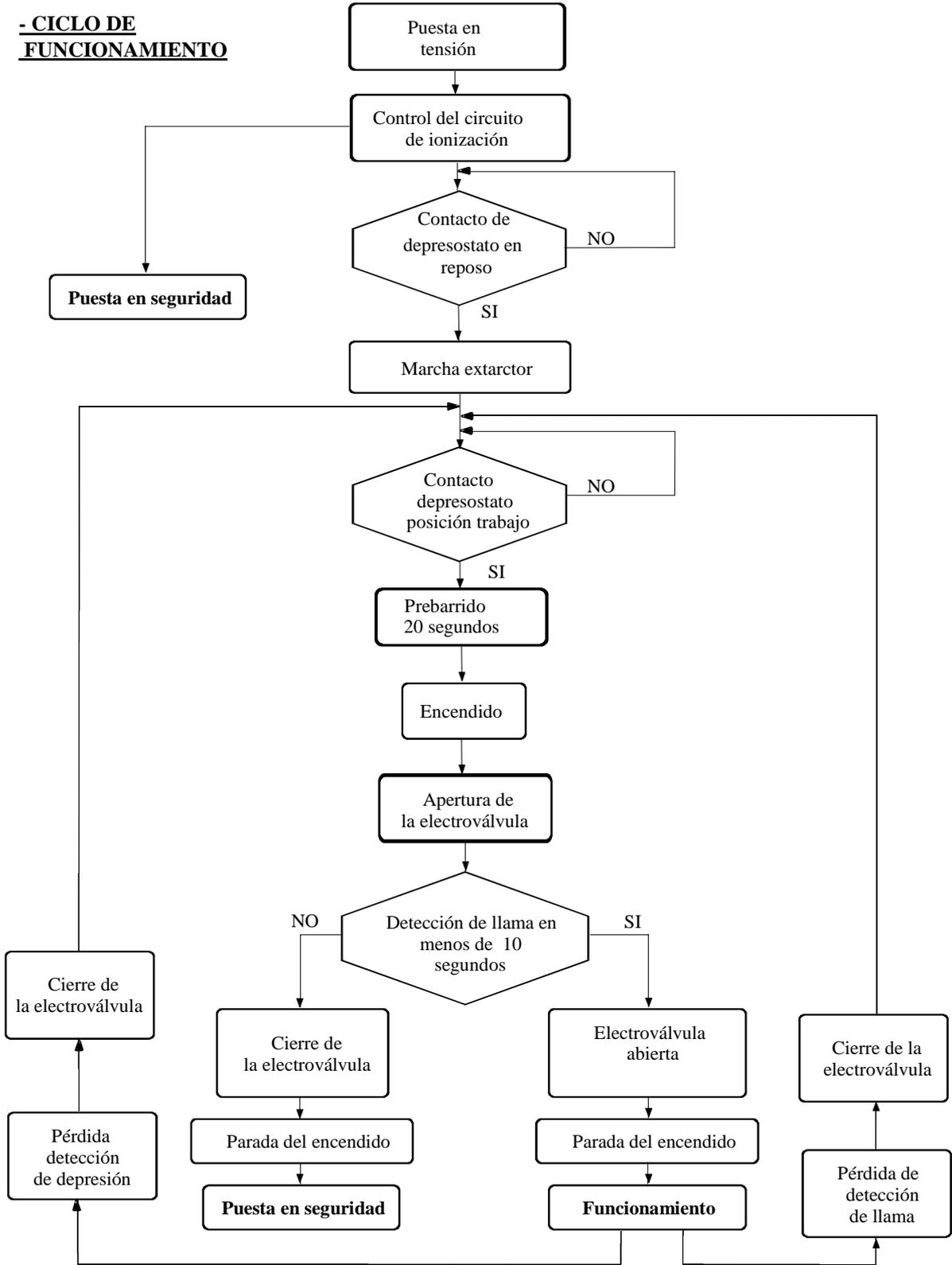
NOTA: Rearme por desconexión eléctrica y nueva conexión.
