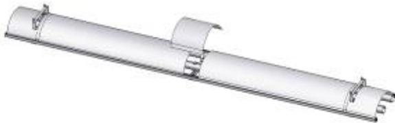
12. Posicionar la pequeña chapa central empalmado sobre los dos reflectores previamente colocados y fijarla hasta hacer “clic” entre los dos perfiles de la estructura-soporte
