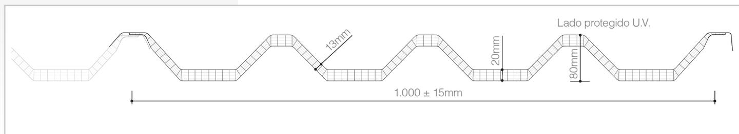
**Sistema modular grecado de policarbonato celular con protección U.V. para cerramientos y cubiertas translúcidas**
