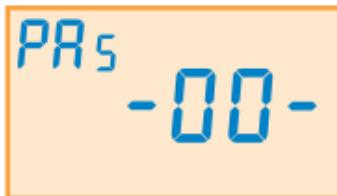
Ao acessar novamente os Parâmetros do Instalador pede-se o password. A tela mostra a seguinte configuração:
