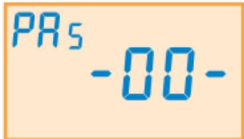
Para acessar à programação de Parâmetros do Instalador, pressione as teclas « **▲** » e « **▼** » por mais de 5 segundos.
