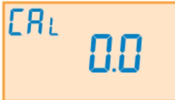
**CAL** → Calibración (offset) sonda de temperatura.
