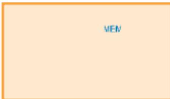
Pressionando «OK» no final da programação dos Parâmetros do Instalador, automaticamente são memorizados os dados programados aparecendo **MEM** no visor.
