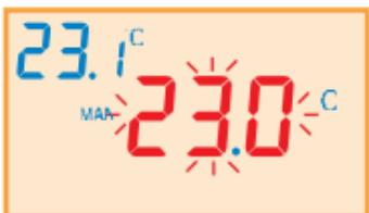
Aparecerá piscando no visor a temperatura (com o valor inferior à temperatura ambiente).
