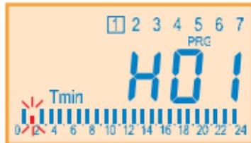
Si se mantiene la selección de **Tmax**, **Tmin** o **Anti-hielo** se sigue confirmando con «OK». En caso de cambiar pulsar «SELECT».
