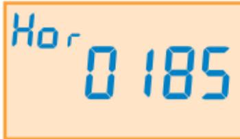
**HOR** → Contador de horas de funcionamiento de la caldera.
