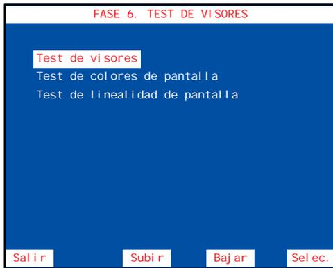
El menú **TEST DE VISORES** permite acceder a tres fases cuya finalidad es comprobar los visores display y facilitar el mantenimiento de los circuitos de video y monitor TFT.
