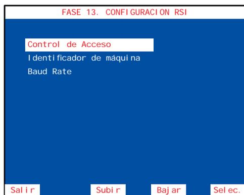
El menú **CONFIGURACIÓN RSI** permite acceder a diferentes fases cuya finalidad es personalizar el acceso a los datos de funcionamiento de la máquina.
