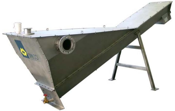
Clasificación de arenas con deshidratación de las mismas mediante sinfín inclinado sin eje.
