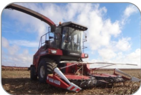
**Figura 2:** Cosechadora de forrajes Gomselmash FS 80-2 equipada con cabezal GSM 4500 tipo rotativo.
