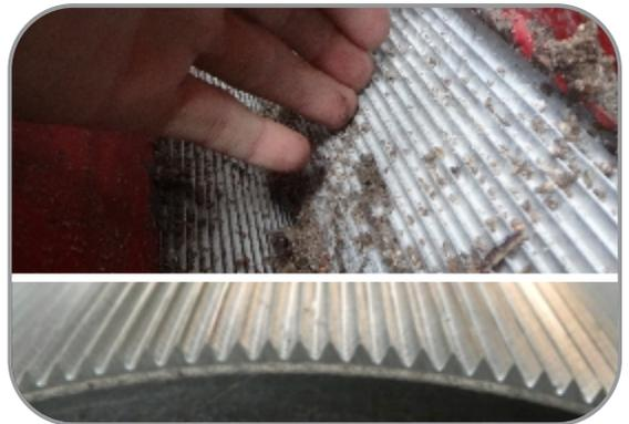
Figura 6b: Detalle de los rodillos con sus dientes acanalados
