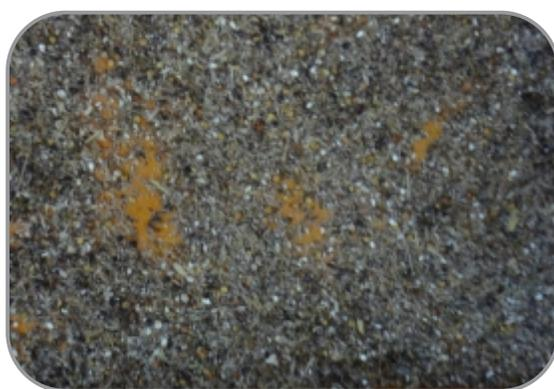
Figura 13: Granos dañados por el sistema procesador
