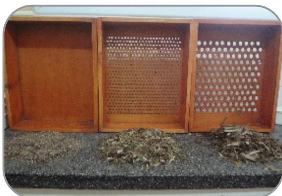
Figura 9: Separador de partículas Penn State, para evaluar tamaños y distribución de partículas del picado. **Derecha:** Bandeja superior, con orificios de 19 mm que retiene todas las partículas superiores a dicha medida. **Centro:** bandeja media que cuenta con orificios de 8 mm y retiene todas las partículas entre 19 y 8 mm. **Izquierda:** bandeja inferior, ciega, donde quedan todas las partículas inferiores a 8 mm (granos)
