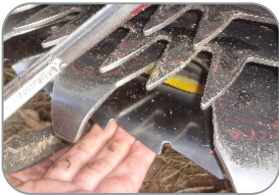
**Figura 4 a y b:** Vista de uno de los platos de arrastre, sus guías fijas de encausado y el disco de corte con cuchillas de impacto
