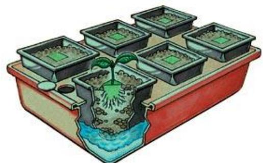
**Sustratos para la hidroponía:** Los sustratos ayudan a sostener las raíces y contener el agua y los nutrientes que las plantas necesitan. Los sustratos más utilizados son cascarilla de arroz, arena, grava, residuos de hornos y calderas, piedra pómez, ladrillos y tejas molidas (libres de elementos calcáreos o cemento), espuma de polietileno, turba rubia y vermiculita.
