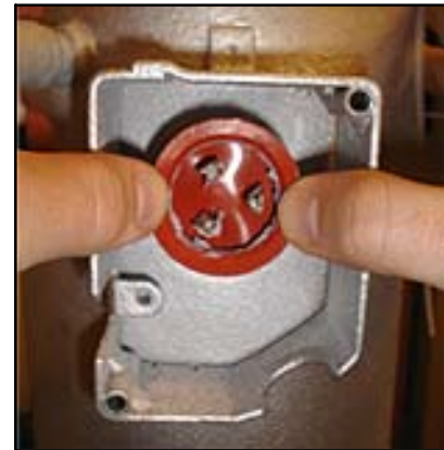
Figura 6-10 Instalación de la Empaquetadura anaranjada
