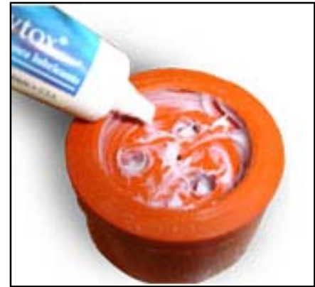
Figura 6-9 Lubricación de la Empaquetadura anaranjada
