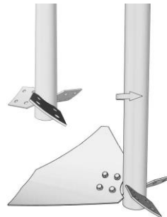
Profil déformé d'écoulement axial. Aspirant à gauche Sens de la norme plié
