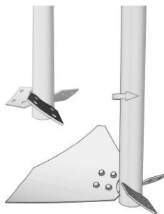
Perfil alabeado de flujo axial. Aspirante a izquierdas Sentido de plegado standard
