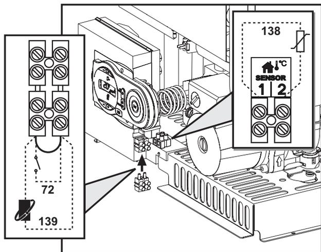
fig. 8 - Acceso a la regleta de conexiones
