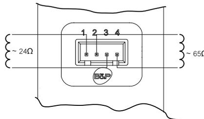
fig. 11 - Conexión de la válvula de gas
